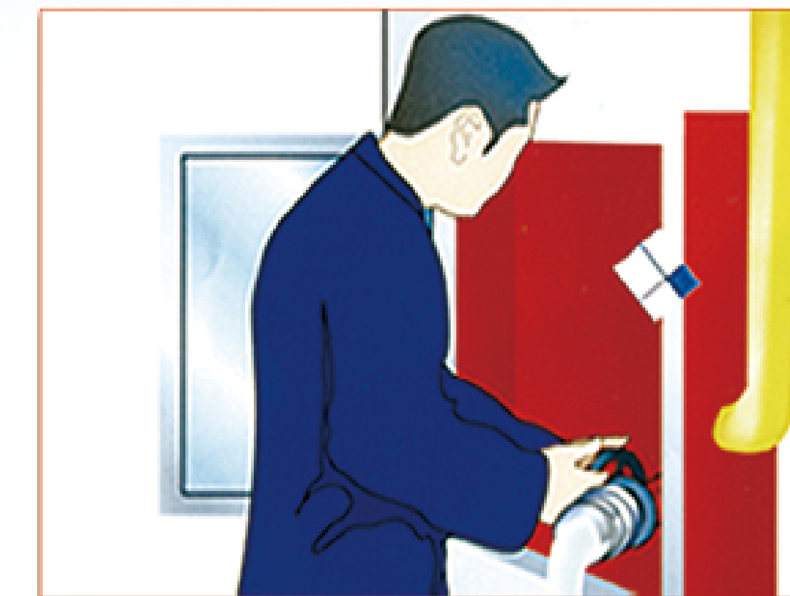
⑤ 另外一人打开消防栓上的水阀开关
